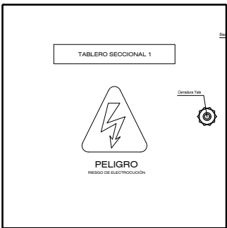
Vista frontal gabinete cerrado
